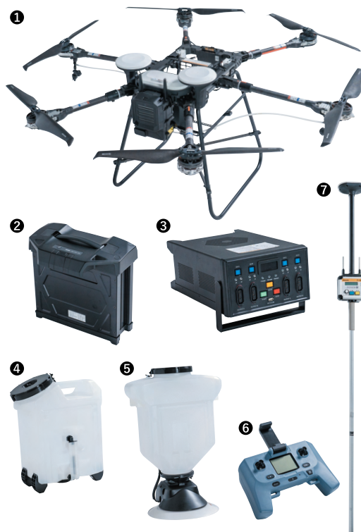
①機体 ②バッテリー ③充電器 ④液剤散布装置 ⑤粒剤散布装置 ⑥プロポ ⑦測量機
