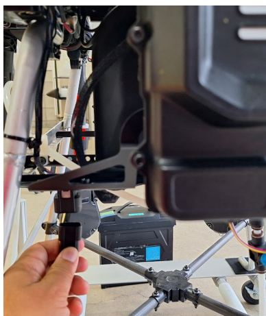
16. スレー側の粒剤機のカプラーに粒剤機のカプラーを差し込みます。
