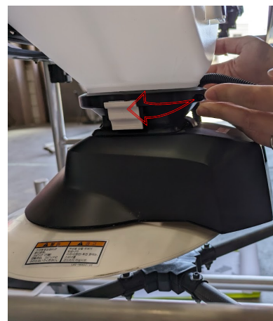
15. ホッパーを白い傘が前方に来るように時計回りに回します。
