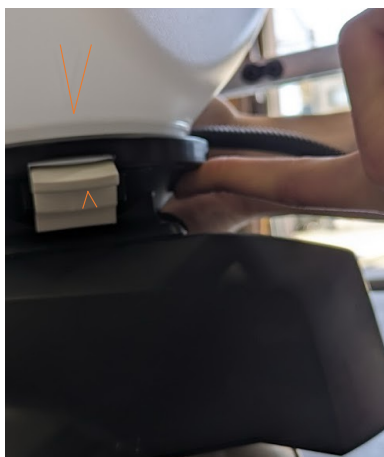
14. ホッパーの合マーク (V) にグラニューラーサブセットの合マーク (V) を合わせて差し込みます。
